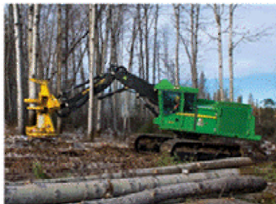
Figura 83 - Abbattimento con feller
