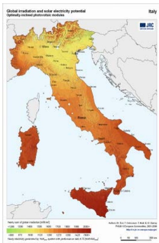
Figura 49 - Potenziale teorico di produzione di energia elettrica da 1 kWp di pannelli fotovoltaici in Italia e in Puglia.
