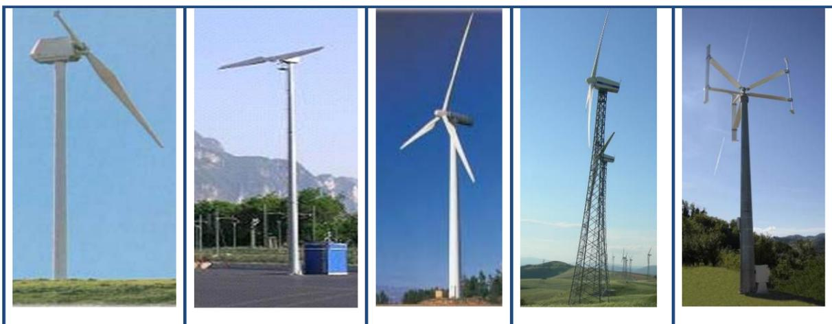
Fig. 35. La tipologia delle macchine (Enea, Energia eolica, Roma, 2000): macchine tubolari, monopala, bipala e tripala; macchine trilitiche; macchine ad asse verticale.
