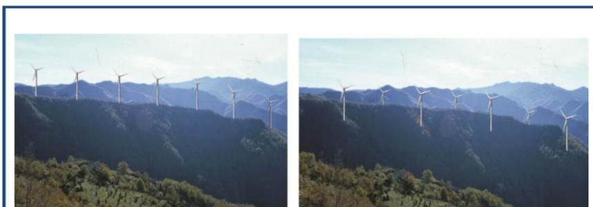
*Fig. 12. Criteri di posizionamento (Regione Toscana, Linee guida per la valutazione dell'impatto ambientale degli impianti eolici, 2004): l'effetto visivo della disposizione lineare lungo la linea del crinale e a cavallo dello stesso.*
