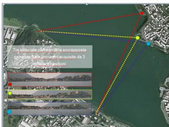
Fig.4 Un esempio di acquisizione di sequenze multiple di immagini con l'ausilio di un sistema PhotoGPS
