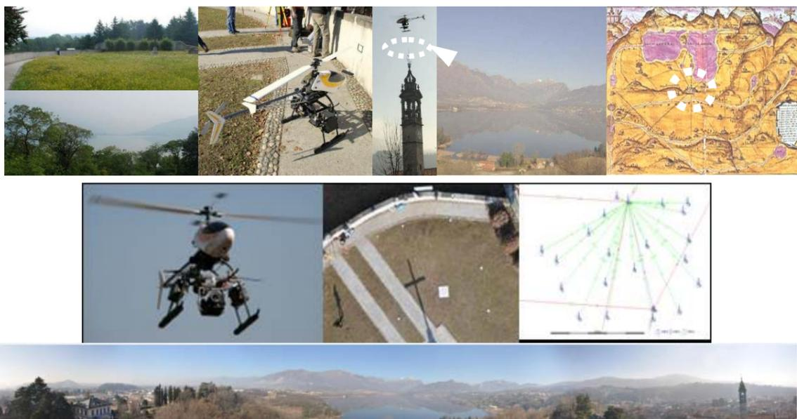
Figure 5. Esempio di una panoramica acquisita da una piattaforma fotogrammetrica RC/UAV per la ricostruzione di uno scenario storico. In basso l'operazione di segnalizzazione a terra di un poligono di test rilevato con GPS.
