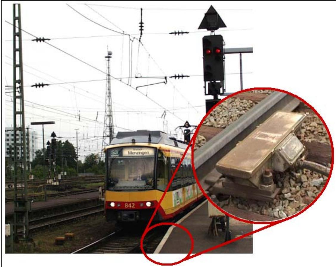
Figura 39. Sistema di segnalamento e ripetizione dei segnali in macchina
